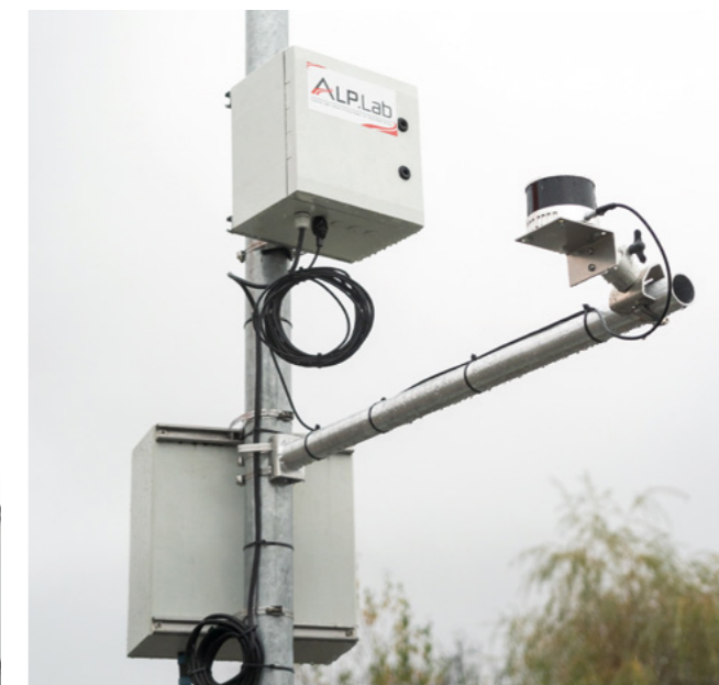
Abbildung 11: Das fertige Sensorsetup, bestehend aus Lidar-Sensor, Verarbeitungseinheit und Pufferbatterie © AustriaTech/Schallauer
