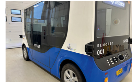
Abbildung 24: Das OHMIO LIFT-Fahrzeug mit verbesserten LiDAR- und Kamerasystemen wird für den Einsatz im REMOTED-Depot in Tampere vorbereitet. ©REMOTED / Tatu Nieminen
